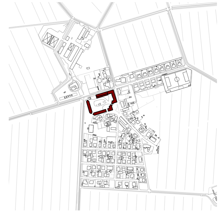
Agenzia n.4 1942 Situata nel centro della frazione di Malisana, si articola attorno a un'ampia corte centrale e comprende una serie di edifici con funzione amministrativa, residenziale e produttiva: due rimesse agricole uguali, un rustico destinato in parte a magazzino e in parte a stalla, un fabbricato di ingresso di tre livelli con porticato passante, destinato ad abitazioni e uffici.
